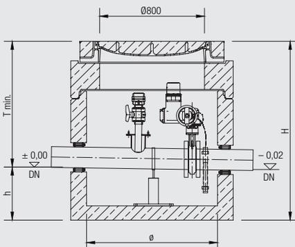
NeutraBloc-A mit Schnellschlussklappe
